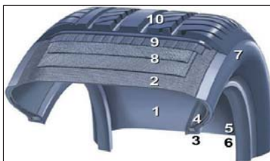
Rys. 1. Fragment opony radialnej z zaznaczonymi elementami dotyczącymi budowy. Źródło: opracowanie własne na podstawie [19].
