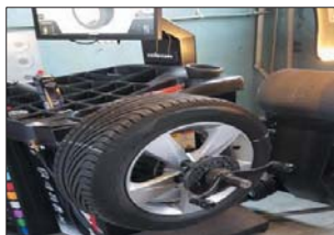
Rys. 3. Wyważarka z zamontowanym obiektem badań. Źródło: opracowanie własne.
