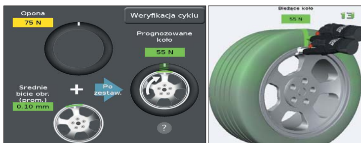
Rys. 7. Poprawne usytuowanie opony względem obręczy. Źródło: opracowanie własne.
