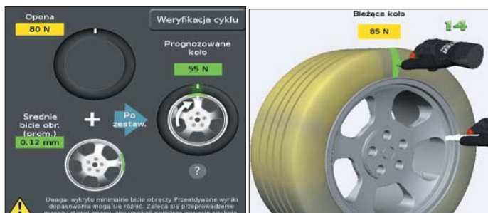
Rys. 6. Proces ustawiania opony względem obręczy koła. Źródło: opracowanie własne.
